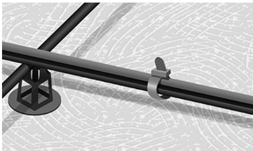
Fig. 5. Kabel fäst. Buntbanden är lösa och sitter inte på skarvar
