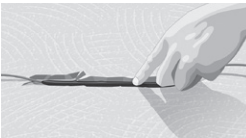
Fig. 2. Rille til kold/varm samling på kablet
