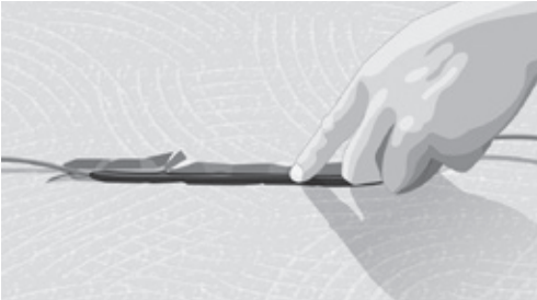
Bild 2. Spår för fog av kyl- och värmekabel
