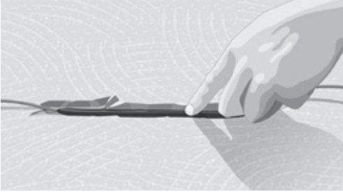
Fig. 2. Spor for kobling mellom kaldkabel og varmekabel
