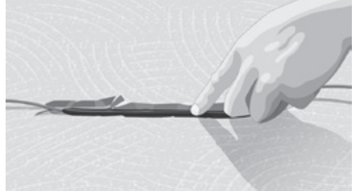
Abb. 2. Nut zur Verbindung von Kalt- und Heizkabel
