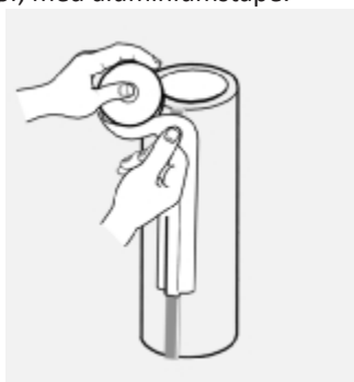
Fig. 4. Varmefordeling på plastrør, med aluminiumstape.
